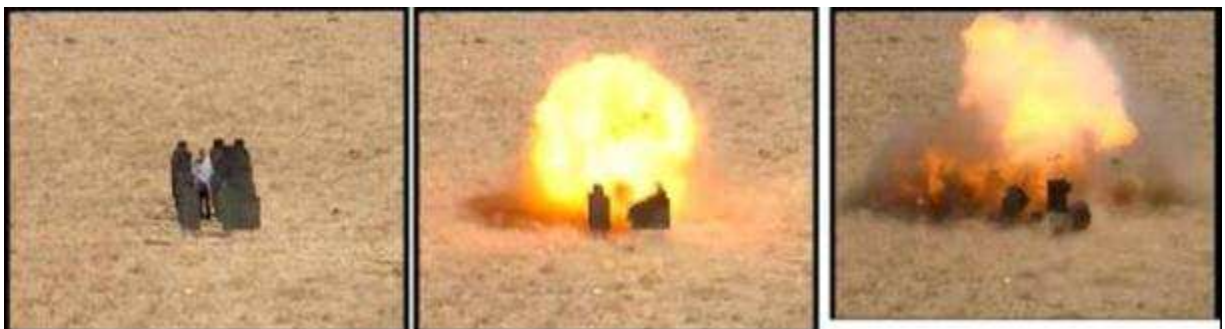
Extrait : Essai d'explosion, les cibles sont placées comme dans un bus.
